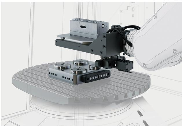
2 Beim neuen Stark-Robotergreifer erfolgt die Übergabe der für Löse- und Spannvorgänge erforderlichen Hydraulik, Pneumatik und Elektrik über die am Palettengreifer integrierte Mehrfachkupplung (© Roemheld)
